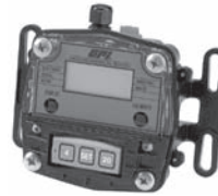
GX500 Display 4-20 mA Output (Remote)
